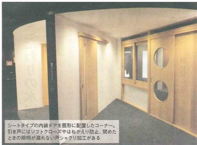
シートタイプの内装ドアを扇形に配置したコーナー。引き戸にはソフトクローズやはねがえり防止、開めたときの照明が漏れない戸シャクリ加工がある
