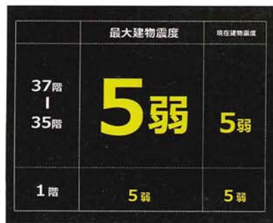
モニター表示画面例【地震発生時（揺れの最中）】 建物の健全性をいち早く診断し、発災後の混乱を回避
